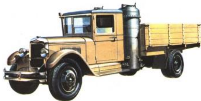
ГАЗ-А с газогенераторной установкой "Автодор-3". 1935 г.
